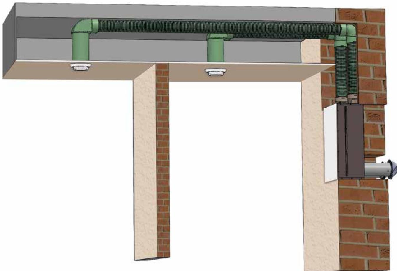
ESEMPIO DI INSTALLAZIONE AD INCASSO PER LA VENTILAZIONE DI PIU' LOCALI, CONDOTTI IN PARETE.
