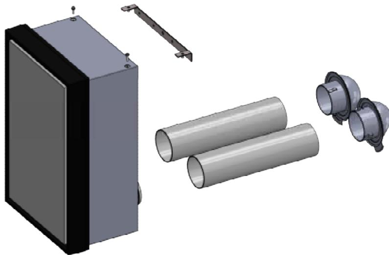
ESEMPIO DI INSTALLAZIONE A SEMI INCASSO SENZA ASPIRAZIONE DA ALTRO LOCALE
